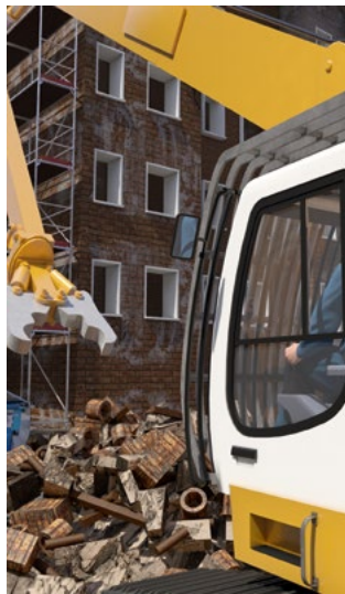
Abb. 94 Kabine mit Schutzgitter
