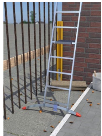
Abb. 45 Leiterfuß zum Ausgleich von Niveauunterschieden
