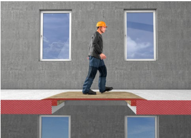
Abb. 3 Sicherung von Deckenöffnungen (Schnittdarstellung)
