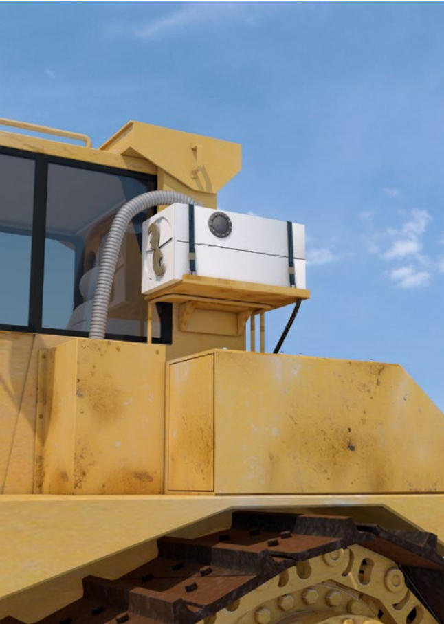
Abb. 15 Filteranlage zur Atemluftversorgung des Geräteführers
