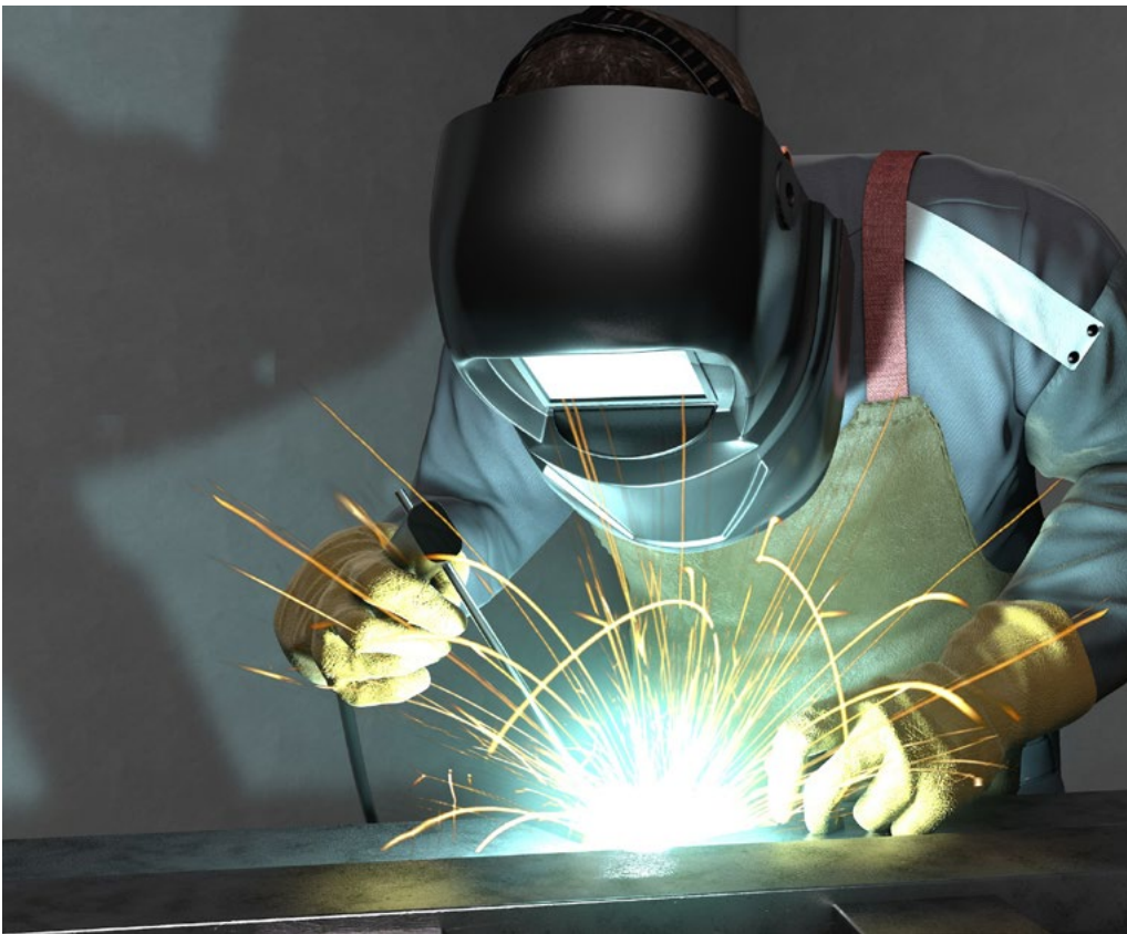
Abb. 54 Schweißen nur mit Schutzausrüstungen
