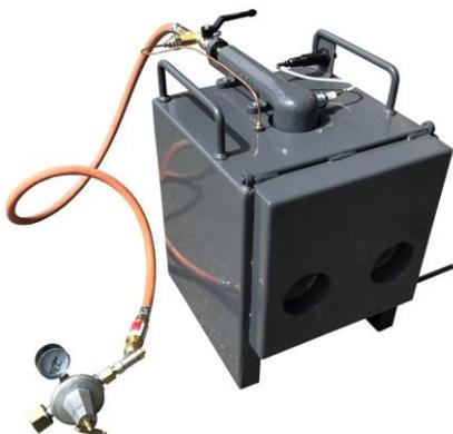
Bild 2: Gasschmiedeofen für den mobilen Einsatz
