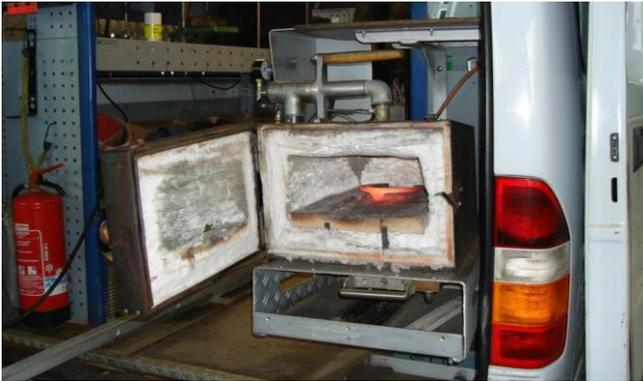
Bild 3: Gasschmiedeofen im Einsatz
